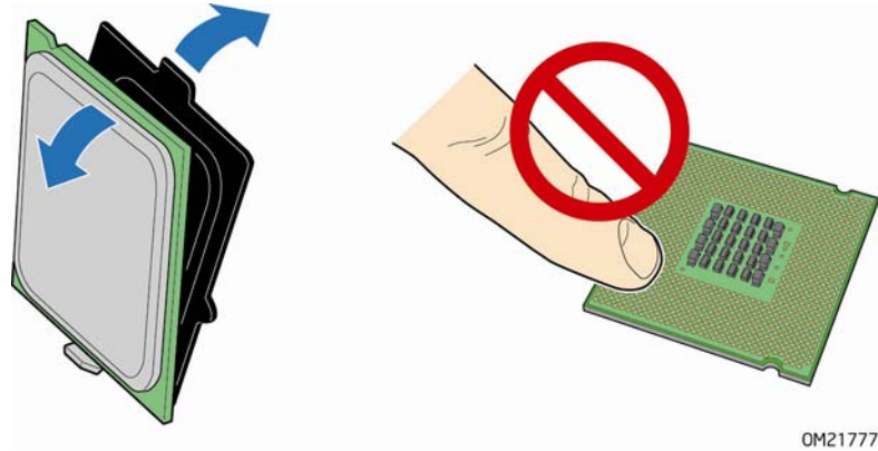
图 9. 从处理器保护罩中取出处理器
